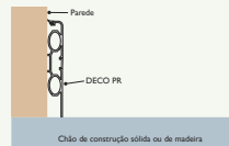
Utilizado como rodapé de aquecimento
